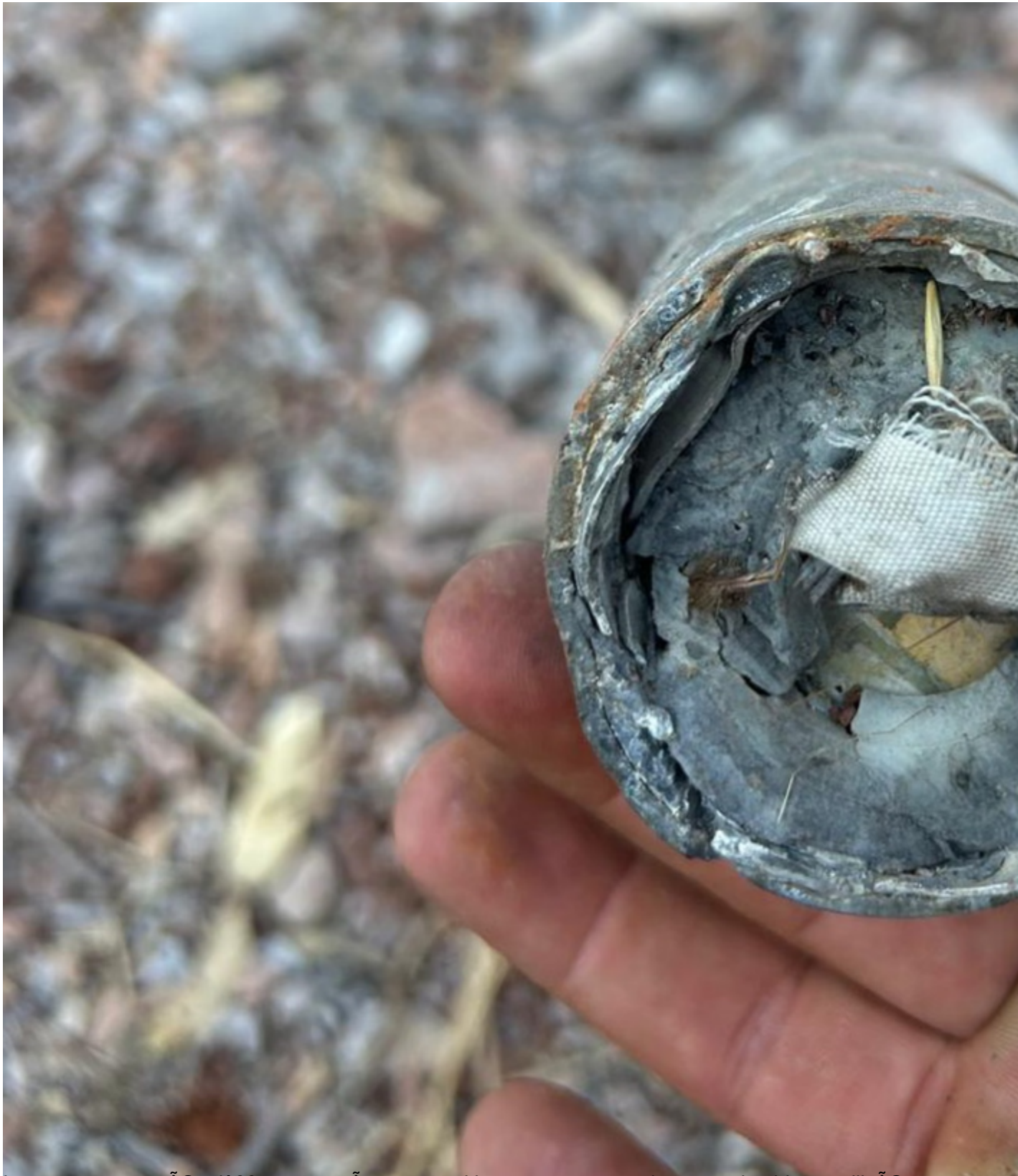
Les restes retrouvés d'une arme à sous-munitions montrent un ruban en nylon blanc, utilisé pour stabiliser et déclencher les sous-munitions.
